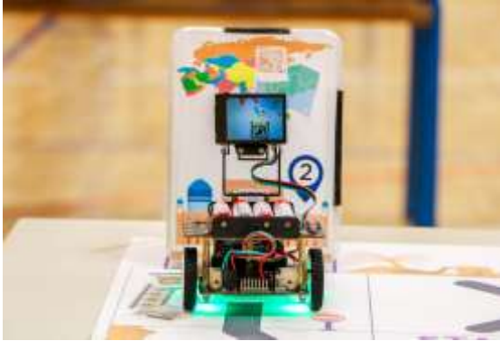
HuskyLens kamera i robot u zadatku 3. kola.
